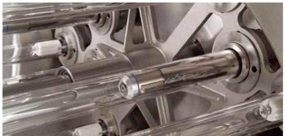
El sistema TrojanUVSwift se ha diseñado de modo que puede tener un sensor por lámpara para facilitar un control muy exacto de la potencia de salida UV y del rendimiento del sistema. El sistema consta de un sensor patrón con trazabilidad al Instituto Nacional de Estándares y Tecnología (NIST) para poder realizar en línea, y de modo sencillo, las calibraciones del sensor.
