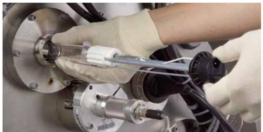
*El sistema se diseñó de modo que fuese fácil de mantener; se puede acceder a todas las tareas rutinarias de mantenimiento desde un solo lado de la cámara.*
